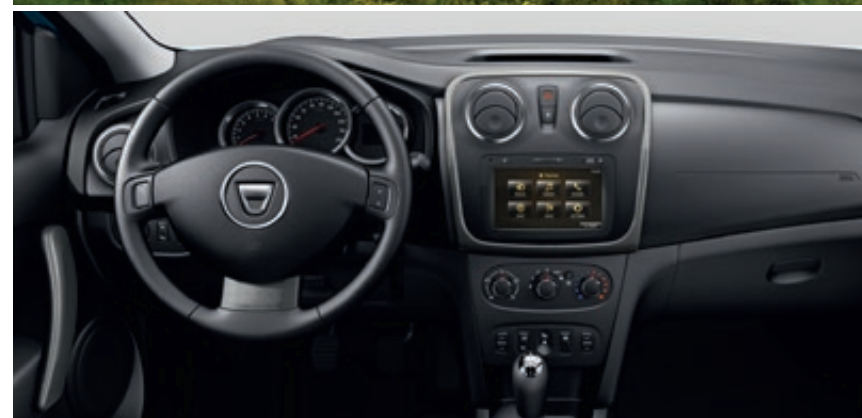
Palubní deska verze Stepway s multimediálním systémem MEDIA NAV a dotykovou 7" obrazovkou, tempomatem a omezovačem rychlosti, klimatizací a zadním parkovacím asistentem.
